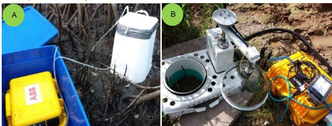
Figura 6.3.A) Analizador de gases (“campanas de gases”) para CH<sub>4</sub> (LGR-ICOS™ GLA131-GGA) y B) Cámara de medición de CO<sub>2</sub> (IRGA) Fotos: Julio Salas.
