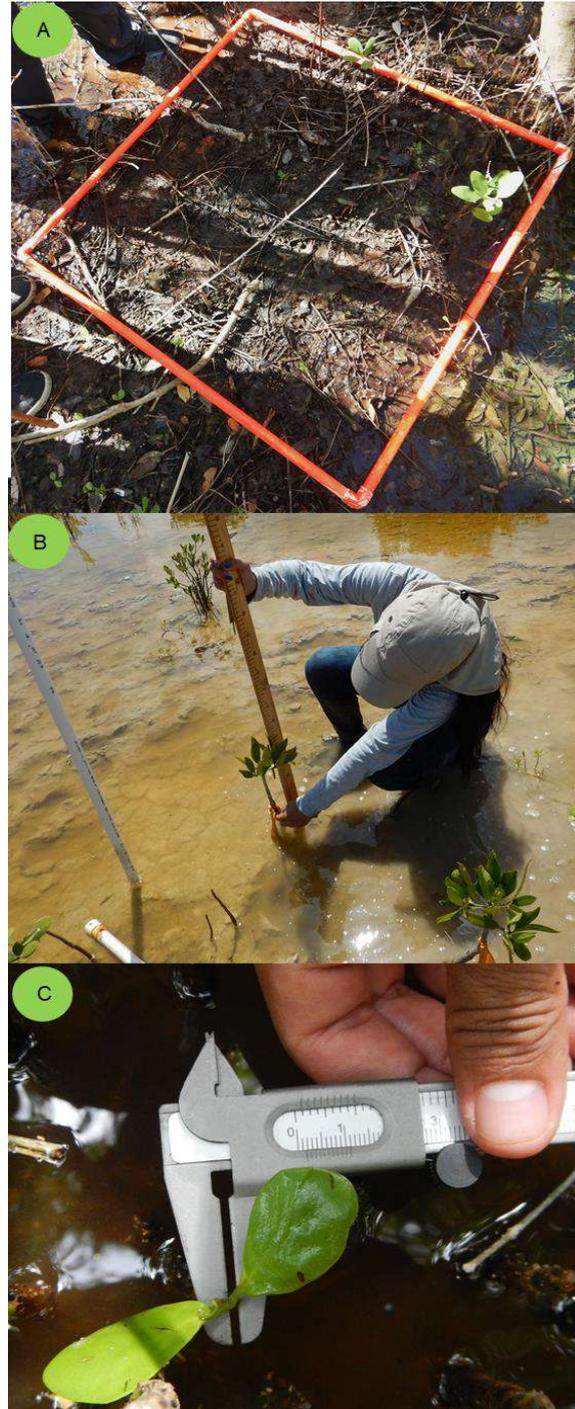
**Figura 4.7. A) sub – parcela de 1 x 1 para la medición de plántulas; B) Medición longitud total de plántula; C) Medición diámetro de plántula con vernier.**
