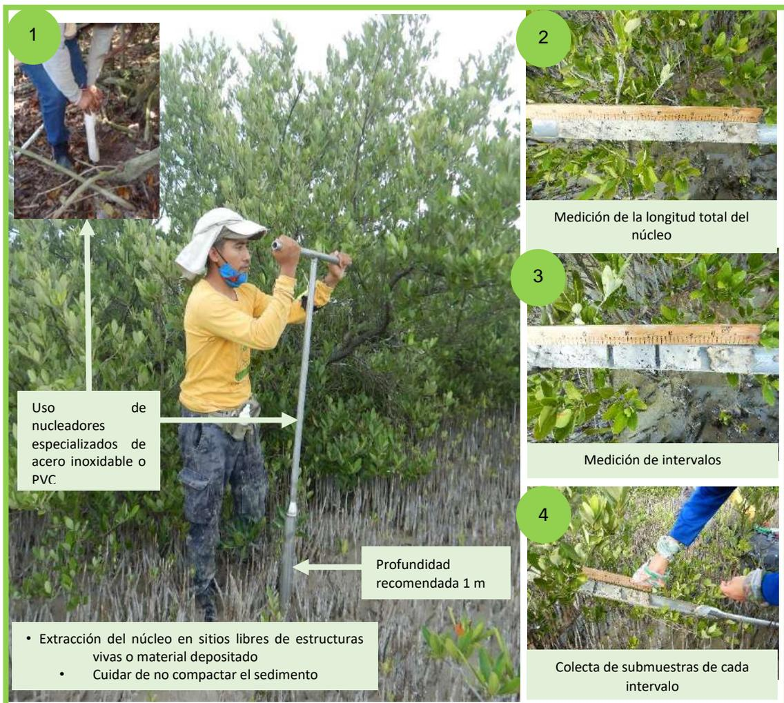
**Figura 4.15. Metodología para la extracción de núcleo de suelo y la colecta muestras para la estimación del carbono orgánico del suelo.**
